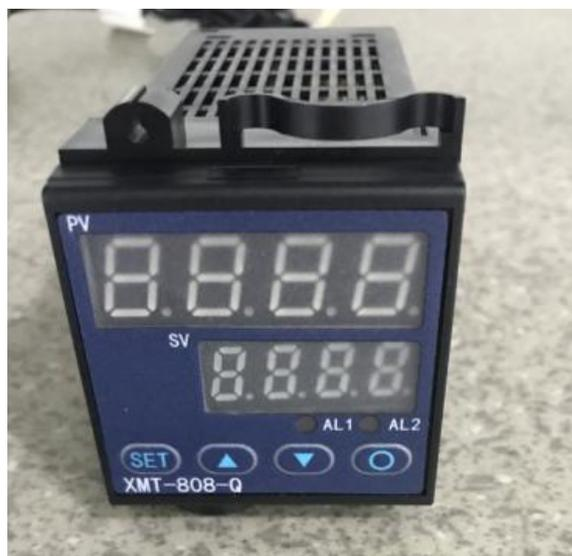
①---测量值显示窗口；②---设定值显示区域；③---报警指示区域；④---按键区。
